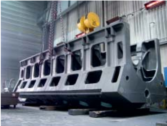
Siempelkamp ist Weltmeister in der Produktion großer Gussteile aus Sphäroguss: Hier ein Motorblock für einen Schiffsmotor.
